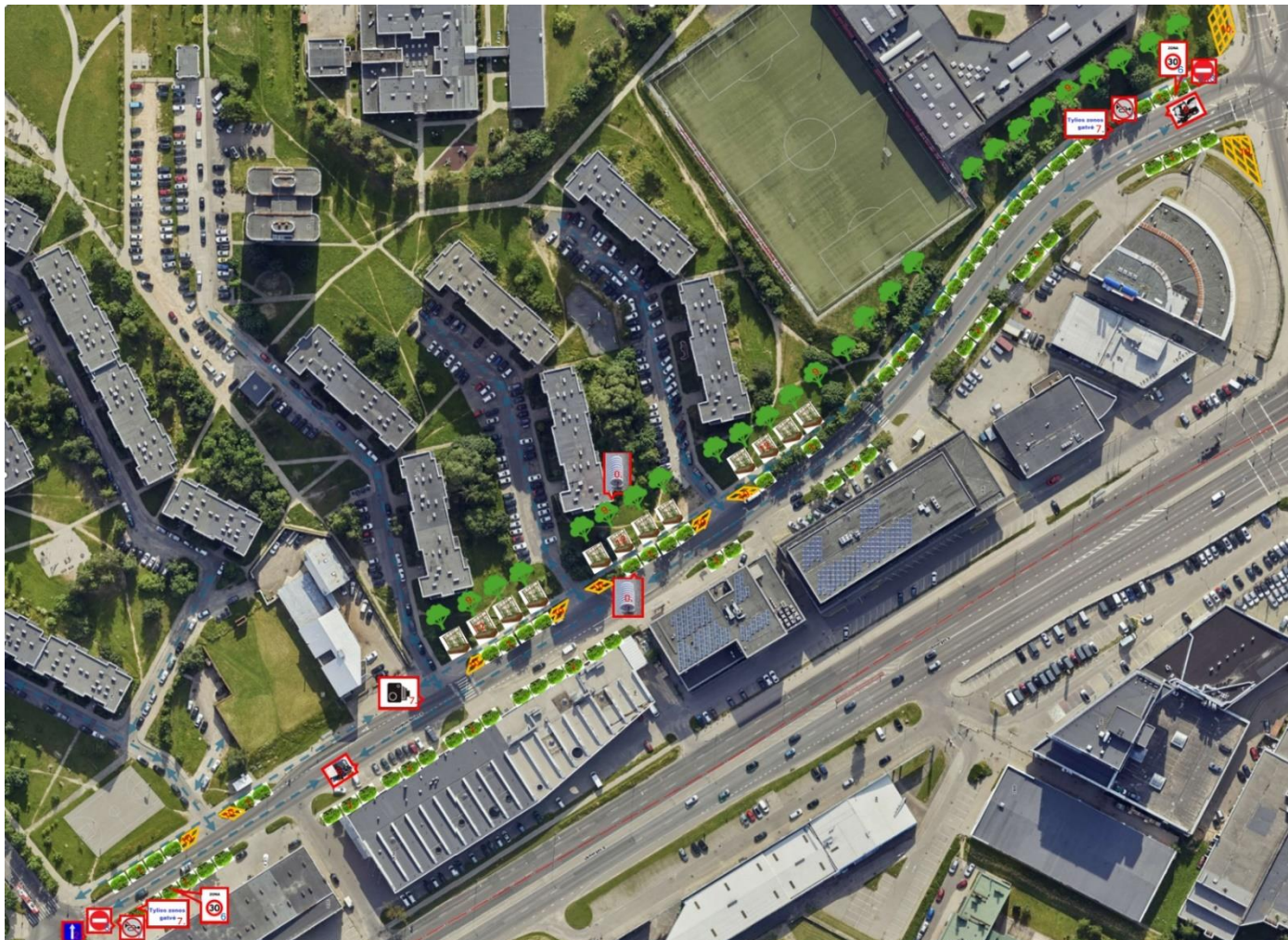
28 pav. Numatytų matavimo prietaisų bei oro ir triukšmo mažinimo priemonių naudojimas ir išsidėstymas vietovėje
