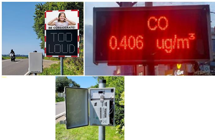
17 pav. Triukšmo ir oro taršos atvaizdavimo LED ekranai ir matavimo įranga
