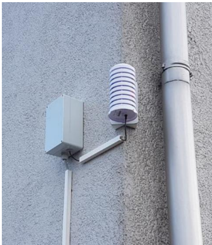
29 pav. Siūlomo oro ir triukšmo matavimo sensoriaus pavyzdys
